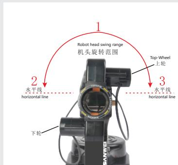
发球机的旋转由调节上下两轮速度和左右调节机头方向来旋转。可发9种旋转球和一种不转球，机头可以在水平180范围内任意往返转动。
